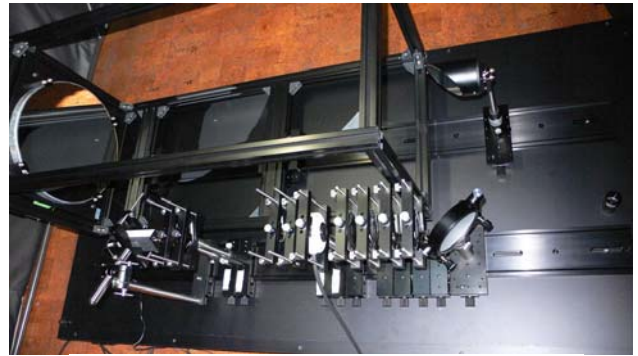
図3：OTR光学システム
