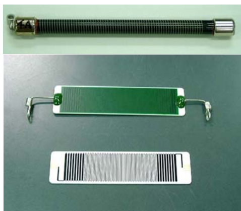
図1：従来型抵抗(上)、無誘導型抵抗(中)及びそのパターン(下)。
