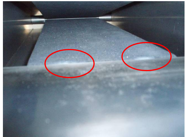
図5: ダミーロード内部放電箇所（第3回電力試験）
