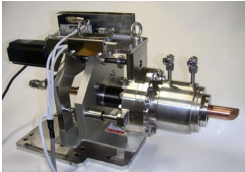
図5 PF-ARのRF空洞を保護するための稼動マスク。
