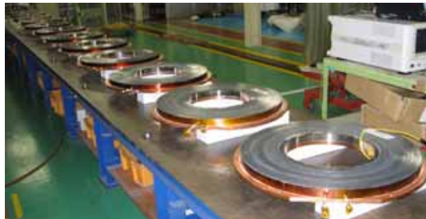
図 2 . 冷却銅板に接着された Co 基アモルファスコア。
