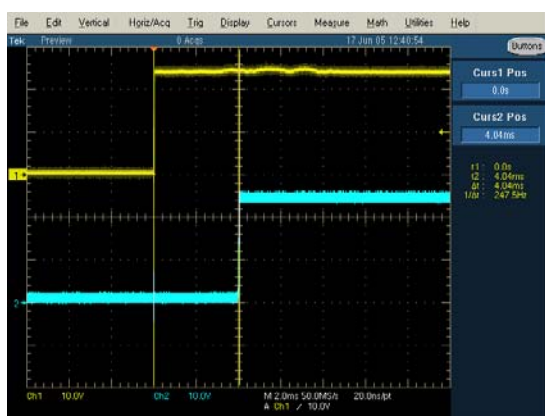
図2：BIS信号出力タイミング (同一ステーション内, 4.04msec.)
