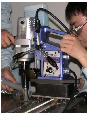
図3 左：溶接部を削っているところ 右：スライドステージ上のドリル
