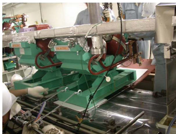
図5. 電磁石の下半分を牽引しているところ
