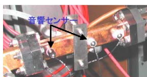
図1 音響センサー 形状 φ10、t 10
