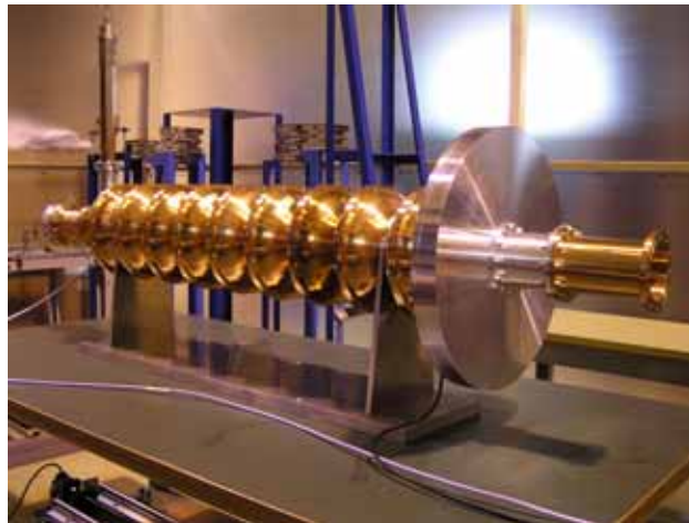
図2 TESLA型9セルモデル空洞に取り付けられたラジアル型HOMダンパー
