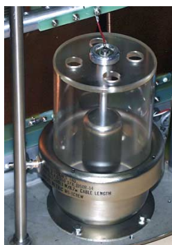
図 1：容量性分圧器 (Stangenes CVD-350)
