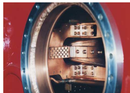
図2：背板に取り付けられた L 型 C チューナー (中央の多数の穴が開いた板)
