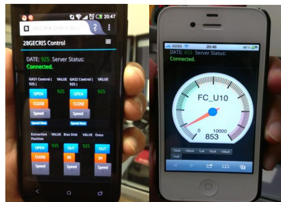
図 4 : 開発中の 28GECR イオン源制御用 GUI パネルを表示させている Android 端末(左)と iPhone 端末(右)
