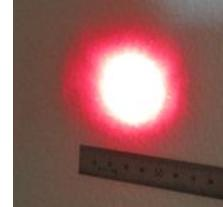
図 6 : 500m 先でのレーザースポット ( $4\sigma=30\text{ mm}$ )
