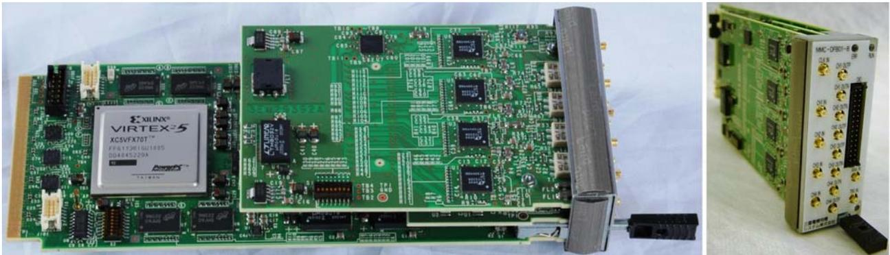
図 4 LLRF 制御ボードの外観
