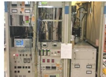
旧型で大型のサブプースタ・クライストロン（右）と電源。
