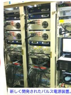
パルス電力が電磁石のコイルに供給されると、電磁石が磁場を発生し適切な特性を持つビームを導きます。コイルが一度パルス電力を受け取ると、今度は逆に電力を返そうとします。以前の電源ではこの戻ってきた電力は熱として捨てられていましたが、この電力を電源のコンデンサで受け取り、20ミリ秒後の次のパルスで再利用することを可能にしました。測定するとその節約割合は69%に達します。1台あたりの電力は約2.5キロワットなので、全体で約100キロワットの電力の節約ができたことになります。
