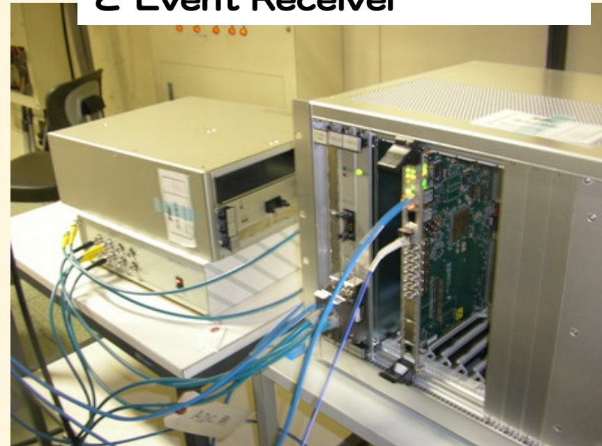
昨年秋から(試験)運用している 3 Sector Sub-booster Station の llrf 用 DAC/ADC, と Event Receiver
